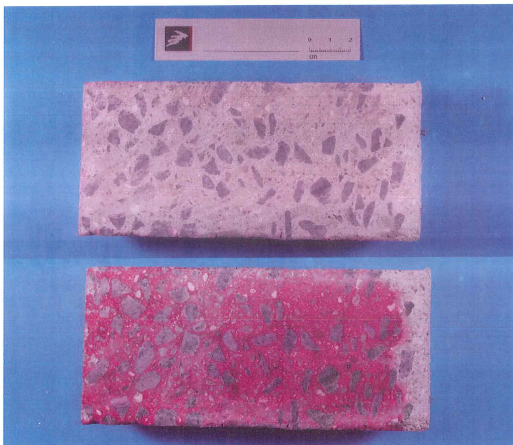
Makrofoto 2: Foto af betonkerne efter gennemskæring med oversiden mod venstre. Den nedre kernehelvdel er påsprøjtet pH-indikatoren phenolphtalein.
